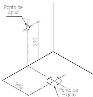
Sugestão de medidas para instalação de lavatórios suspensos sem coluna.
