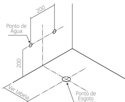
Sugestão de medidas para instalação bacias com caixa acoplada com saída horizontal, apoiadas no piso.
