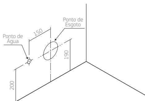
Sugestão de medidas para instalação de bacias convencionais com saída horizontal, apoiadas no piso ou suspensas.
