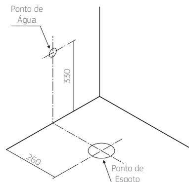
Sugestão de medidas para instalação de bidês. Dimensões válidas para os bidês de piso exceto B.32 - Bidê Dream. Verificar sugestão de medidas no folheto de instrução de instalação.
